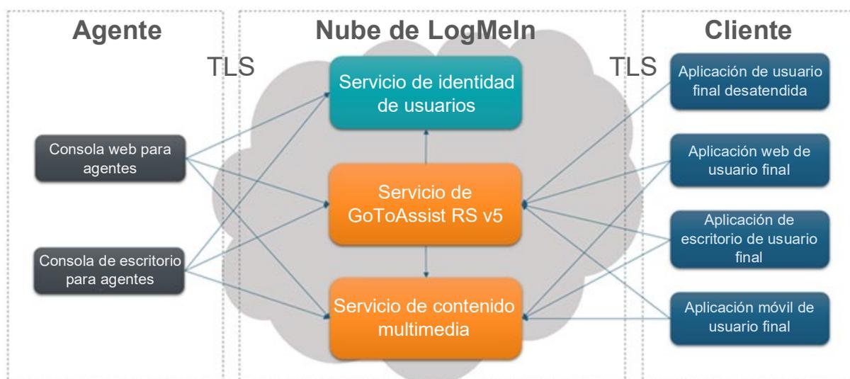
La autenticación de agentes utiliza el servicio de identidad de usuarios de GoTo. Las comunicaciones entre los participantes en una sesión de GoToAssist Remote Support v5 se realizan a través de una pila de red superpuesta, situada de forma lógica encima de la pila de TCP/IP y UDP convencional. Esta red la proporcionan el Servicio de GoToAssist Remote Support v5 y el Servicio de contenido multimedia, alojados en Amazon AWS.
